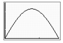
Determinado o máximo desta função temos o ponto de coordenadas ( $\approx 0.7854;25$ ) sendo a primeira coordenada um valor aproximado de  $\frac{\pi}{4}$ .
